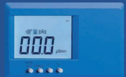
Monitorización Agua Tipo II
